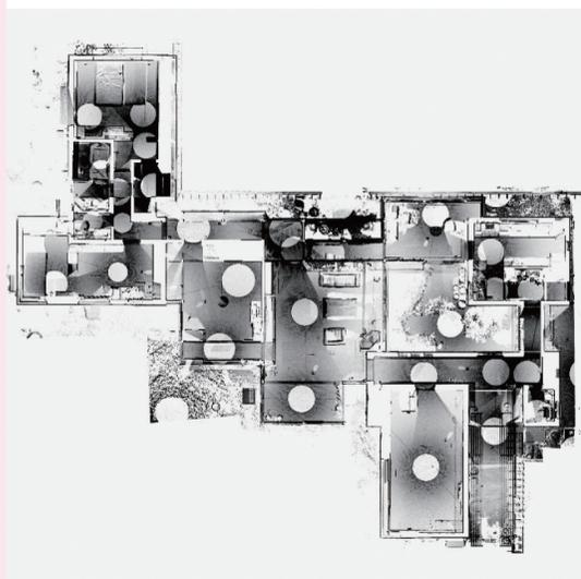
fig.06 中山邸平面図オルソ画像/寸法情報を持った画像で専用のソフトで自動的に作成でき、CADなどに取り込んで使用できる
