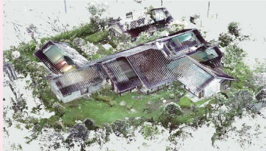
fig.01 3Dスキャナにより取得した中山邸外観の点群データ。
