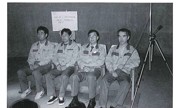
写真4 4脚の椅子による吸音基本特性試験
